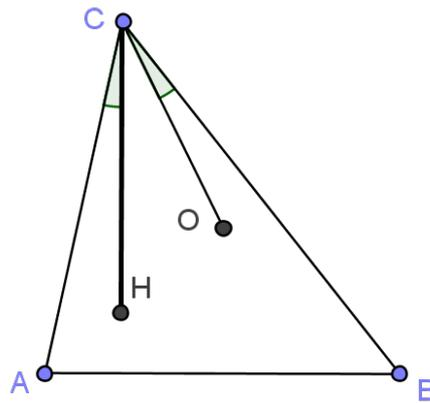
**4 свойство.** Расстояние от вершины треугольника до ортоцентра в 2 раза больше расстояния от центра описанной окружности до противоположной стороны.
