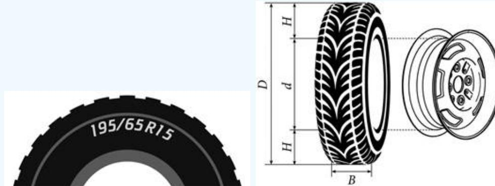
Автомобильное колесо, как правило, представляет из себя металлический диск с установленной на него резиновой шиной. Диаметр диска совпадает с диаметром внутреннего отверстия в шине.
