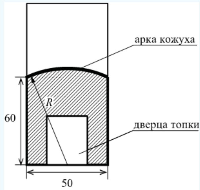
Печь снабжена кожухом вокруг дверцы топки. Верхняя часть кожуха выполнена в виде арки, приваренной к передней стенке печки по дуге окружности с центром в середине нижней части кожуха (рис. 2).
